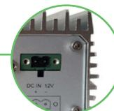
Bornier à vis pour câble d'alimentation électrique
